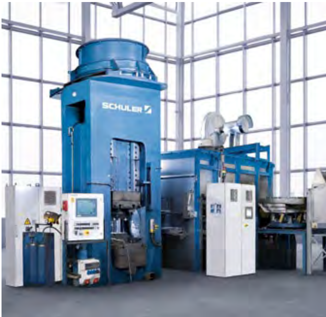
Screw press type PAR 265f for manufacturing aluminum forgings.
